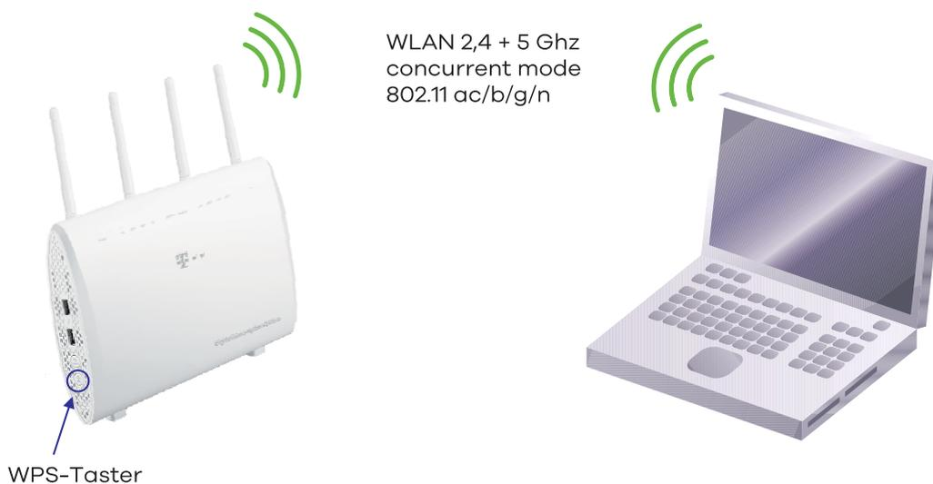
**Abbildung 1** WLAN-Verbindung mit WPS aktivieren
