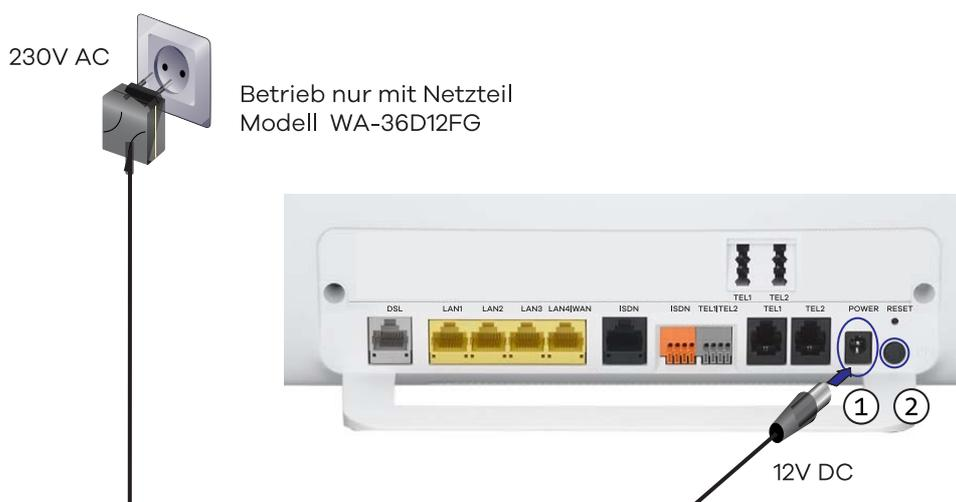
Abbildung 7 Stromversorgung anschließen
